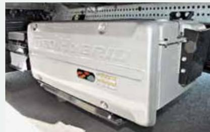
По левому борту грузовика подвешен блок батарей весом 63,5 килограмма
