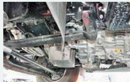
Коробка передач механическая, электронноуправляемая, 6-ступенчатая
