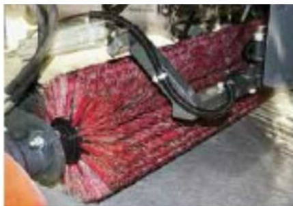
Центральная щетка, расположенная в базе, приводится гидромотором
