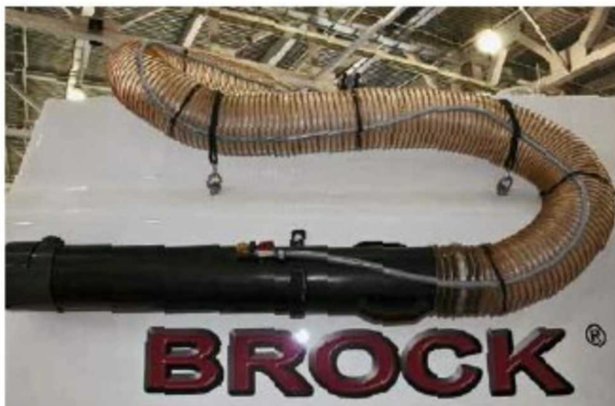
Гибкий шланг мощного пылесоса установлен практически в самом центре крыши бункера, что позволяет эффективно работать по всему периметру машины
