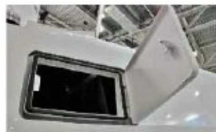
Если мусор негабаритный, его забрасывают в бункер вручную, через окно
