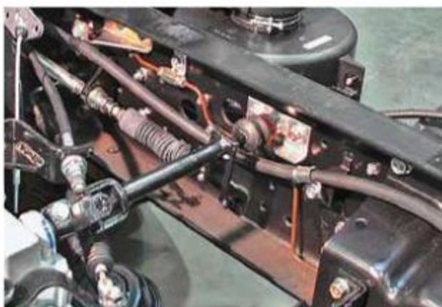
В управлении коробкой главное – следить за герметичностью чехлов
