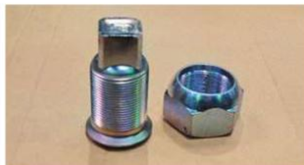
Размер ключа для гайки колеса S=41. Вся надежда – на качественный цинк
