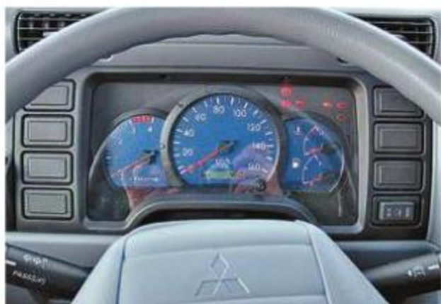
Панель пока без модного дисплея, проводка – без CAN-шин
