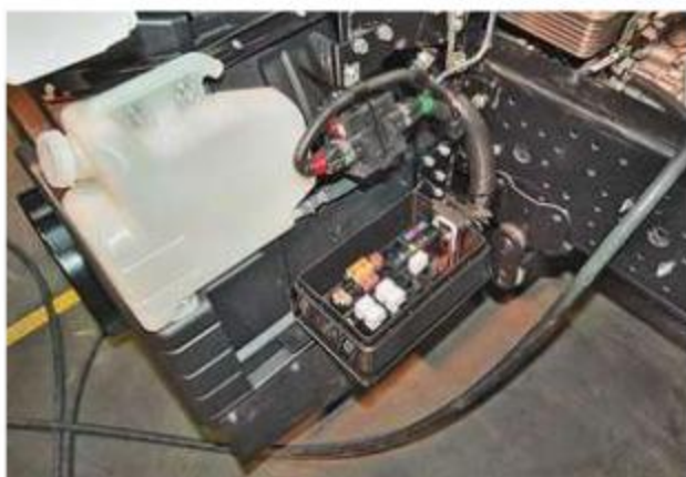
За передним левым колесом расположен блок реле и предохранителей...
