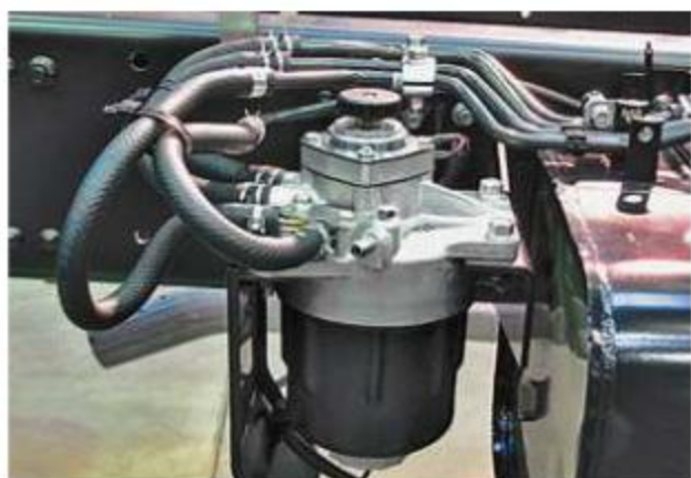
Для России нужен топливный фильтр-отстойник с подогревом
