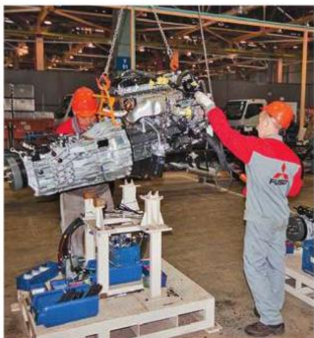
Мотор, коробка идут на комплектацию именно японских Mitsubishi Canter
