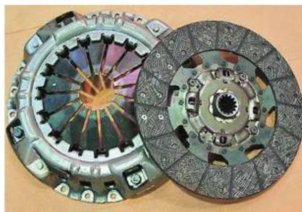
Лепестки «корзины» – без подпятника. Заклинит выжимной – сожжет пружину
