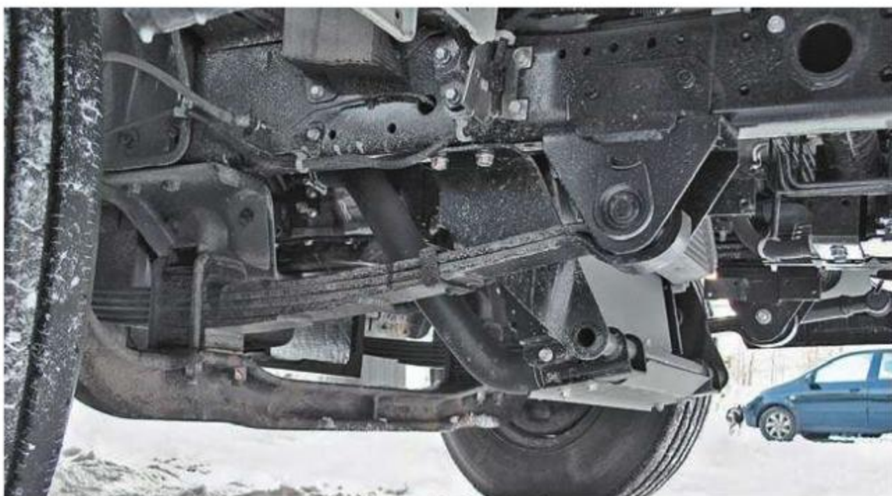
Радиатор системы охлаждения установлен очень низко. Ниже – только балка переднего моста. Проблему можно легко решить при локализации
