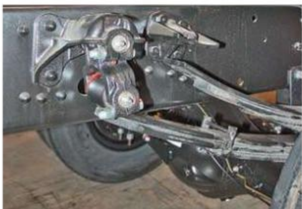
Надо не лениться, смазывать пальцы и втулки задних рессор...
