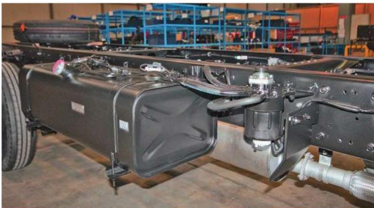
В баке тоже нужен подогрев топливоприемника. Можно использовать электрический, а можно и жидкостный, от системы охлаждения двигателя
