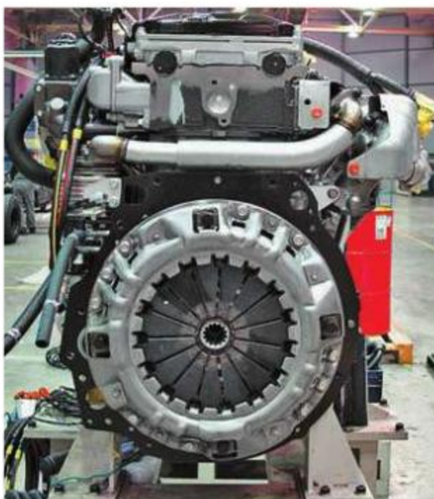
Коробка передач крепится к блоку двигателя дюжиной болтов
