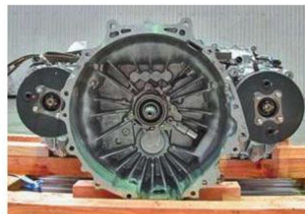
Стояночный тормоз барабанный, установлен на вторичном валу коробки
