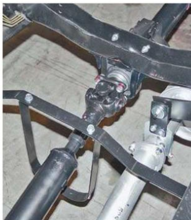
У «японцев» кардан состоит из двух частей. Соединяется – фланцем
