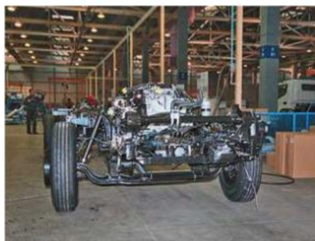
Рама Canter постепенно обрастает навеской. Конвейера пока нет
