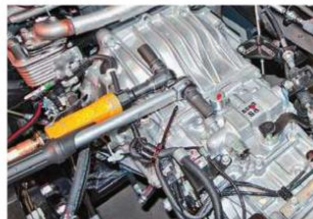
В коробке шесть передач, диапазон чисел: от 5,4 до 0,71
