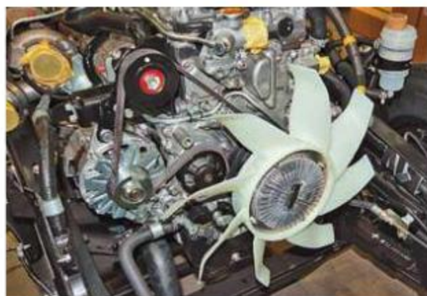
В приводе вентилятора – вязкостная муфта и поликлиновой ремень
