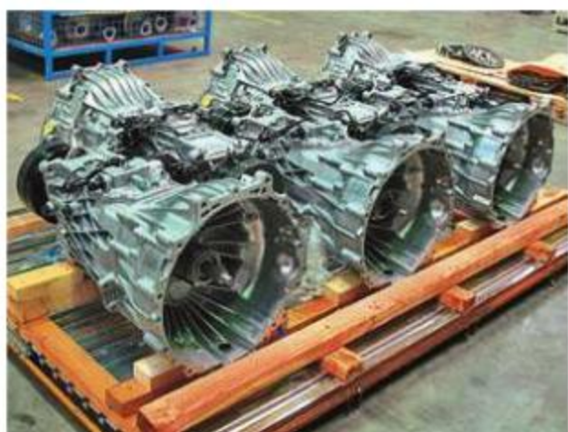
У коробок есть лючок для отбора мощности к приводу гидронасоса
