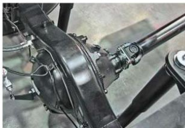
Редуктор – экономичный, гипоидный. Дифференциал – самоблокирующийся
