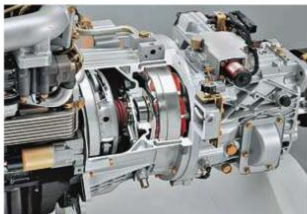
...между сцеплением и механической коробкой установлен электромотор
