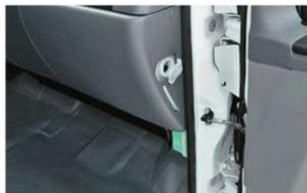
В торце проема пассажирской двери спрятан резервуар омывателя
