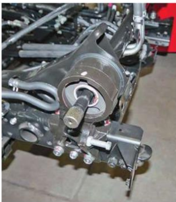
Этот торсион помогает водителю без надрыва позвоночника поднять кабину
