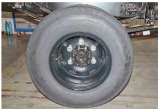
Колеса закреплены шестью шпильками. У задних колес – футорки
