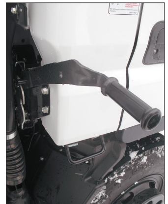
РЫЧАГ ЗАМКА КАБИНЫ УДОБЕН И ЛЕГКОК В ОБРАЩЕНИИ
