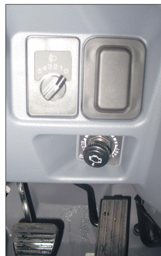
РЕГУЛЯТОР ОБОРОТОВ ХОЛОСТОГО ХОДА ДИЗЕЛЯ УДОБЕН ЗИМОЙ
