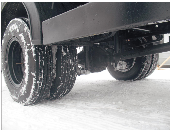
МОЩНАЯ РАМА И ЗАДНЯЯ ПОДВЕСКА РОССИЙСКОГО CANTER ВЗЯТЫ ОТ БОЛЕЕ ТЯЖЕЛОЙ МОДЕЛИ FIGHTER
