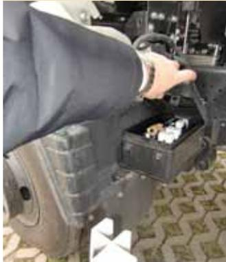
Блок реле за передним колесом
