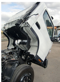
...нужно вручную поднять кабину
