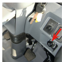
Обороты холостого хода двигателя можно регулировать
