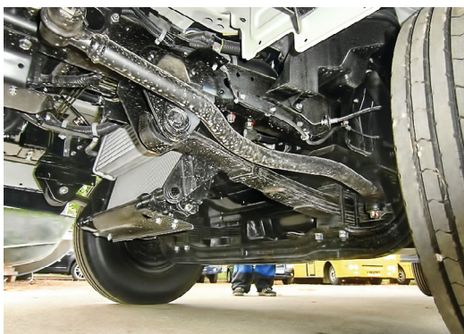
Впереди рессоры и никаких стабилизаторов
