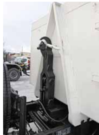
Крюк с автоматическим замком рассчитан на захват всех распространенных контейнеров
