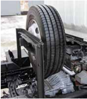
Расположенное за кабиной запасное колесо «съедает» полезную длину рамы шасси
