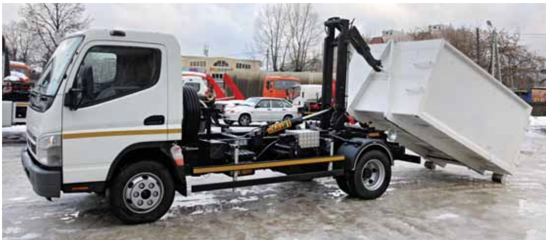
При снятии контейнера он опирается на поверхность двумя роликами. Если грунт мягкий, то даже широкие «катки» завязнут. Выбирайте место для разгрузки
