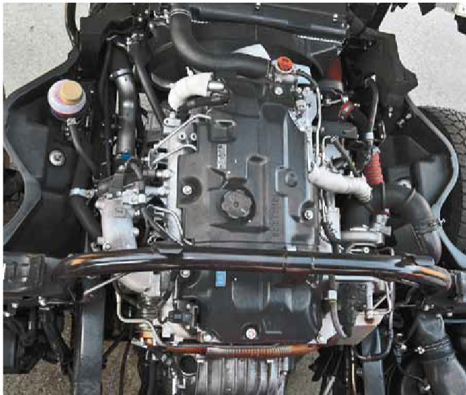
С 2013 года на Mitsubishi Fuso Canter ставят 180-сильные двигатели, отвечающие нормам Евро-4. Моторы работают ровно, тихо и почти без вибраций
