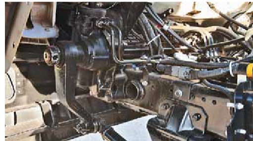
Рулевой механизм на Mitsubishi Fuso Canter, как правило, не требует ремонта в течение всего срока службы машины
