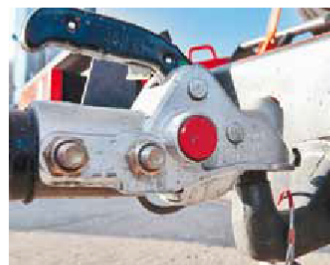
Масса прицепа до 3,5 т допускает применение ТСУ шарового типа – 50 мм
