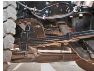
Пятилистовые рессоры спереди можно при желании усилить, добавив листы
