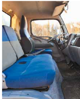
Рычаг КП – на консоли панели приборов, проход за руль – свободный
