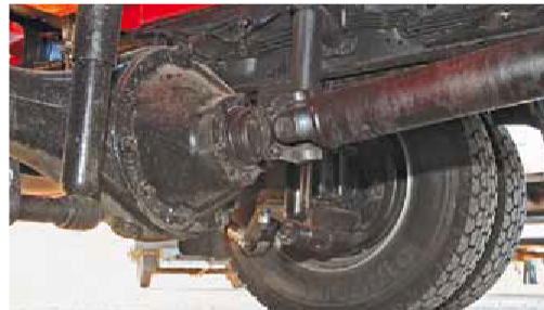
Конструкция заднего моста типа «банджо» позволяет снимать редуктор в сборе, что вряд ли понадобится...
