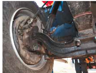
Тормоза всех четырех колес – барабанные, привод – гидравлический
