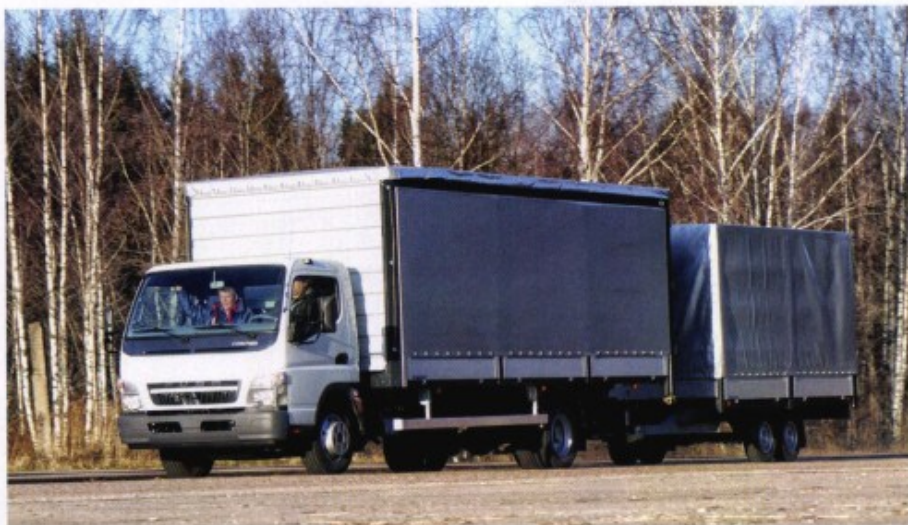
Автопоезд «ЦТТМ» общей длиной 13 320 мм
