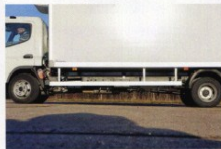
Нижние точки: защита двигателя и «банка» глушителя
