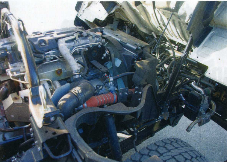
На автомобиле установлен 4,9-литровый дизель Mitsubishi 4M50-5AT5
