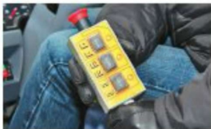
Выносной пульт управления имеет герметичное исполнение
