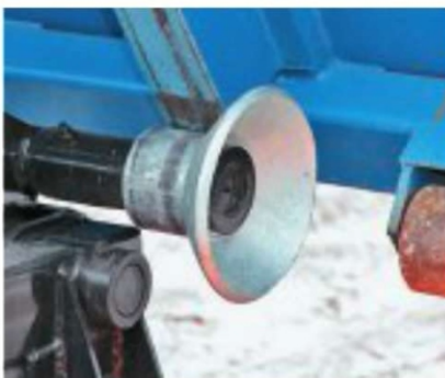
Ролики выполнены из сплава, поглощающего ударные нагрузки
