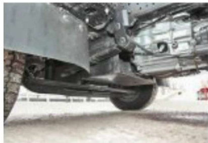
В креплении передней малолистовой рессоры применяется серья
