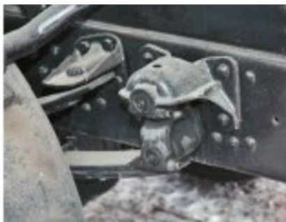
Задняя подвеска – рессорная с мощными подрессорниками
