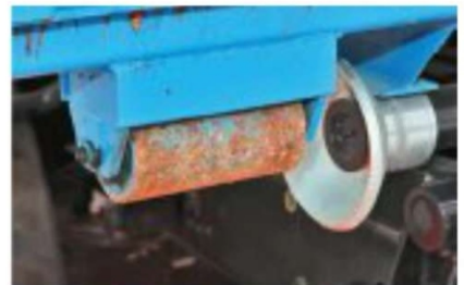
Контейнер оснащается довольно широкими роликами
