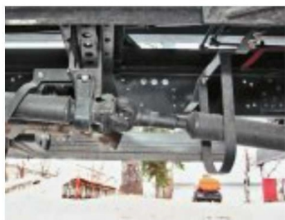
Кardanый вал с промежуточной опорой. Есть петля-ловушка
