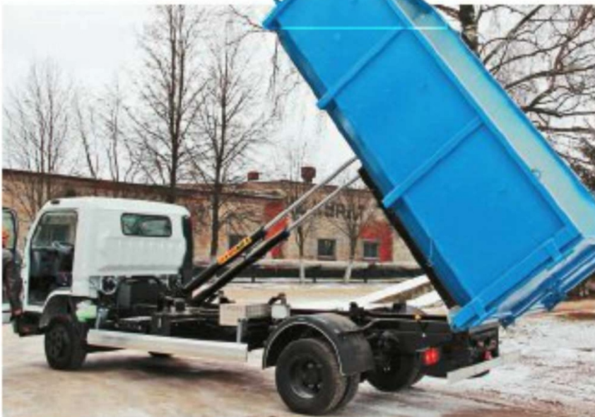
Неоспоримое преимущество машины, оборудованной крюковым гидравлическим погрузчиком, – возможность работать в самосвальном режиме
