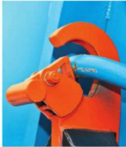
Крюк гидравлического подъемника оснащен надежной защелкой
