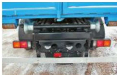
К заднему свесу рамы закреплен противоподкатный брус
