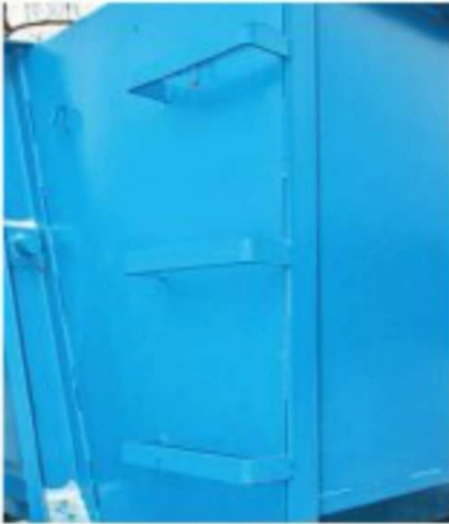
Для осмотра содержимого контейнера сбоку предусмотрена лестница
