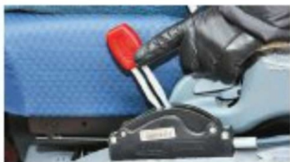
Привод включения гидравлической системы – механический
