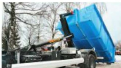
Длины рамы достаточно для работы с 4,7-метровыми контейнерами
