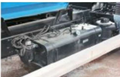
Топливный бак стальной, закрыт мощным металлическим отбойником
