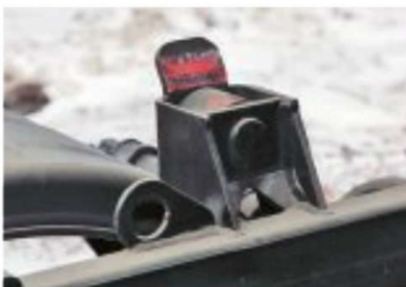
Опоры контейнера имеют собственные ролики, облегчающие погрузку
