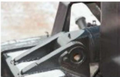
Шарниры силовых гидравлических цилиндров необходимо шприцевать
