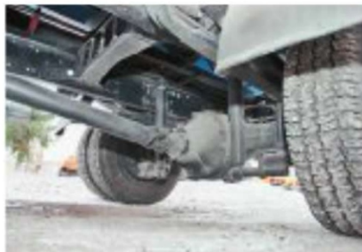
Задняя подвеска оснащается гидравлическими амортизаторами
