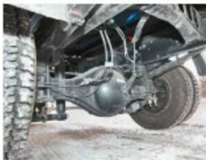
Стремянки крепления рессор задней подвески откручиваются снизу
