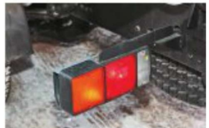
Крепления фонарей из-за жестких условий эксплуатации могут треснуть
