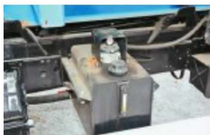
Бак гидравлической системы стальной с измерителем уровня масла
