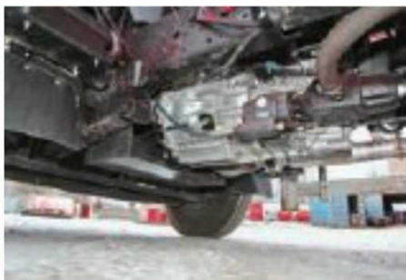
Насос гидравлической системы приводится через коробку отбора мощности
