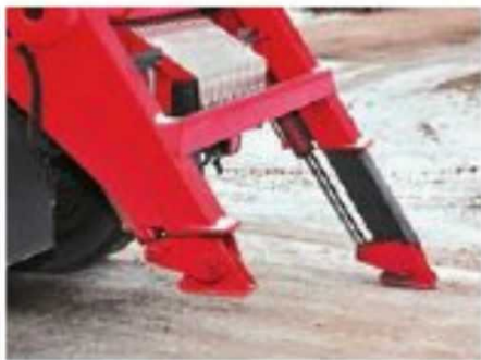
Опоры выдвигаются на разное расстояние, обеспечивая устойчивость шасси
