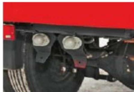
Лампы подсветки номерного знака в герметичных корпусах
