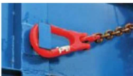
Для фиксации петлю нужно накинуть на «кнехты» и повернуть на 90 град.
