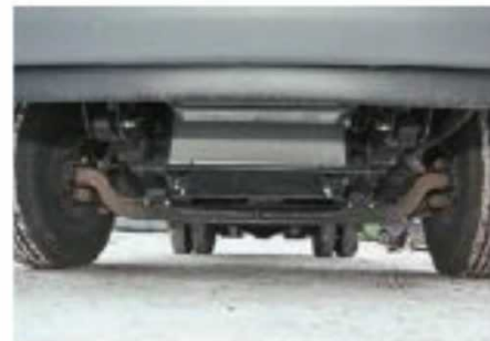
Балка переднего моста «ушастая». Радиатор стоит прикрыть защитой
