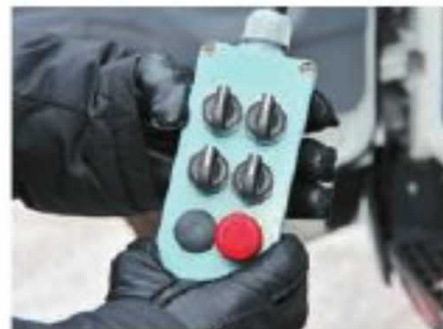
Пульт управления – в герметичном исполнении. Работать можно и в дождь
