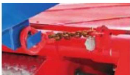
Для работы в самосвальном режиме цепь набрасывают на нижние «кнехты»
