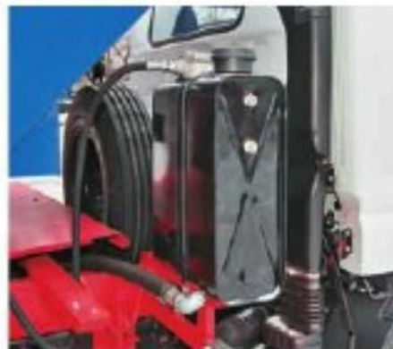
Металлический бак гидравлической системы – за кабиной справа
