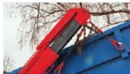
Для снятия контейнера с шасси цепи накидывают на оба верхних крепления
