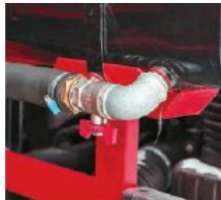
Для удобства обслуживания гидросистемы имеется запорная аппаратура
