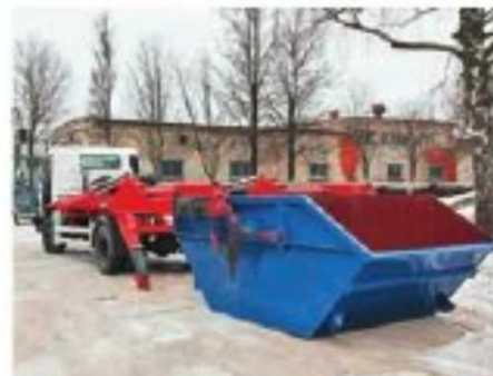
Благодаря телескопируемым стойкам машина может подвинуть контейнер
