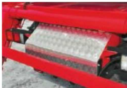
Элементы, подверженные воздействию грязи, закрыты металлическим листом
