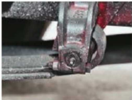
Не забывайте смазывать палец втулки при каждом техобслуживании
