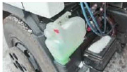
Бачок для жидкости омывателя расположен за кабиной слева
